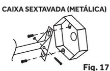
Para instalações em outro tipo de teto, forro falso ou gesso, analise antes o peso do aparelho para absoluta firmeza. Parafusar o suporte de fixação na caixa metálica com 02 parafusos e porcas adequadas\*. Fig. 18.\*Não inclusos.
